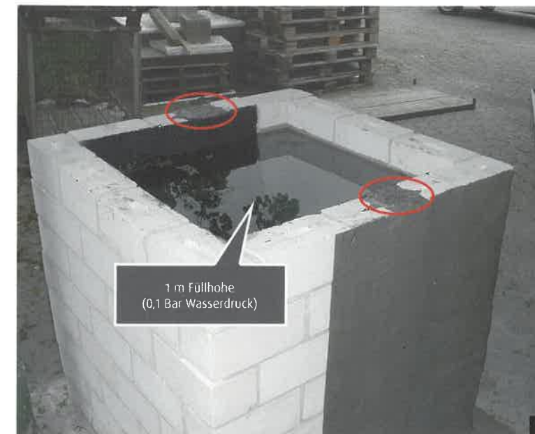
Abb. 9: Simuliert wurde dabei ein Wasserdruck von 0,1 Bar.
