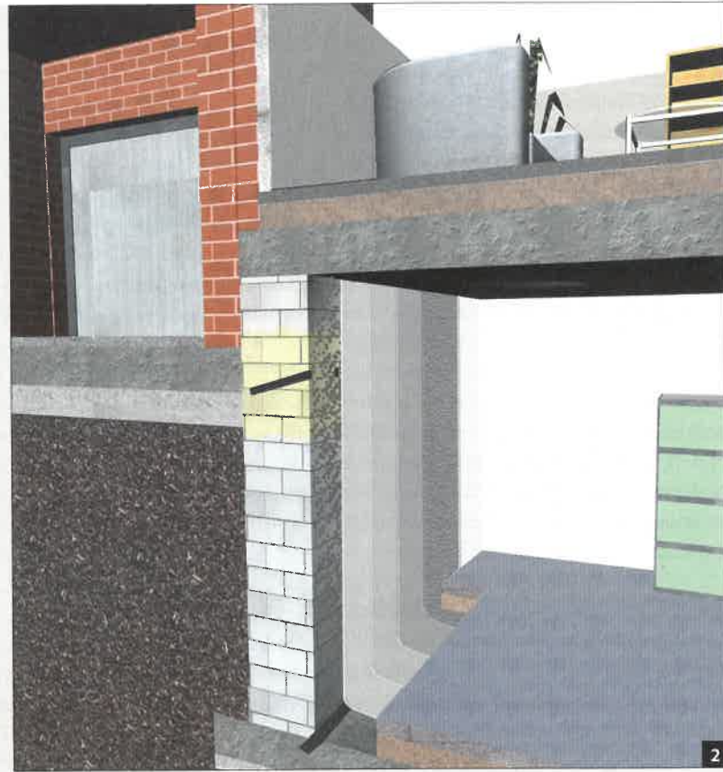
Abb. 2: ... im Bestand sind die abzudichtenden Bauteile oft von außen aber nicht zugänglich, so dass nur eine Abdichtung von innen als Lösung infrage kommt. Diese Abdichtungsbauweise wird im WTA-Merkblatt 4-6-14/D „Nachträgliches Abdichten erdberührter Bauteile“ geregelt.
